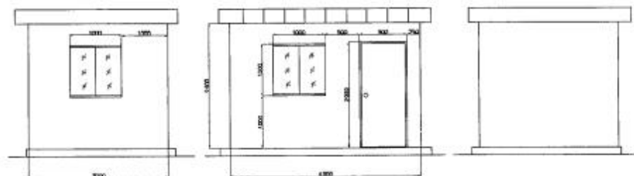
图 4.1 彩钢板监测子站建议尺寸图
