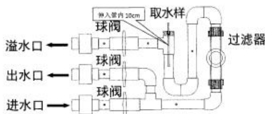
图 4.6 管道安装原理图
