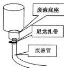
图 4.7 废液管安装示意图
