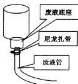
图 4.7 废液管安装示意图
