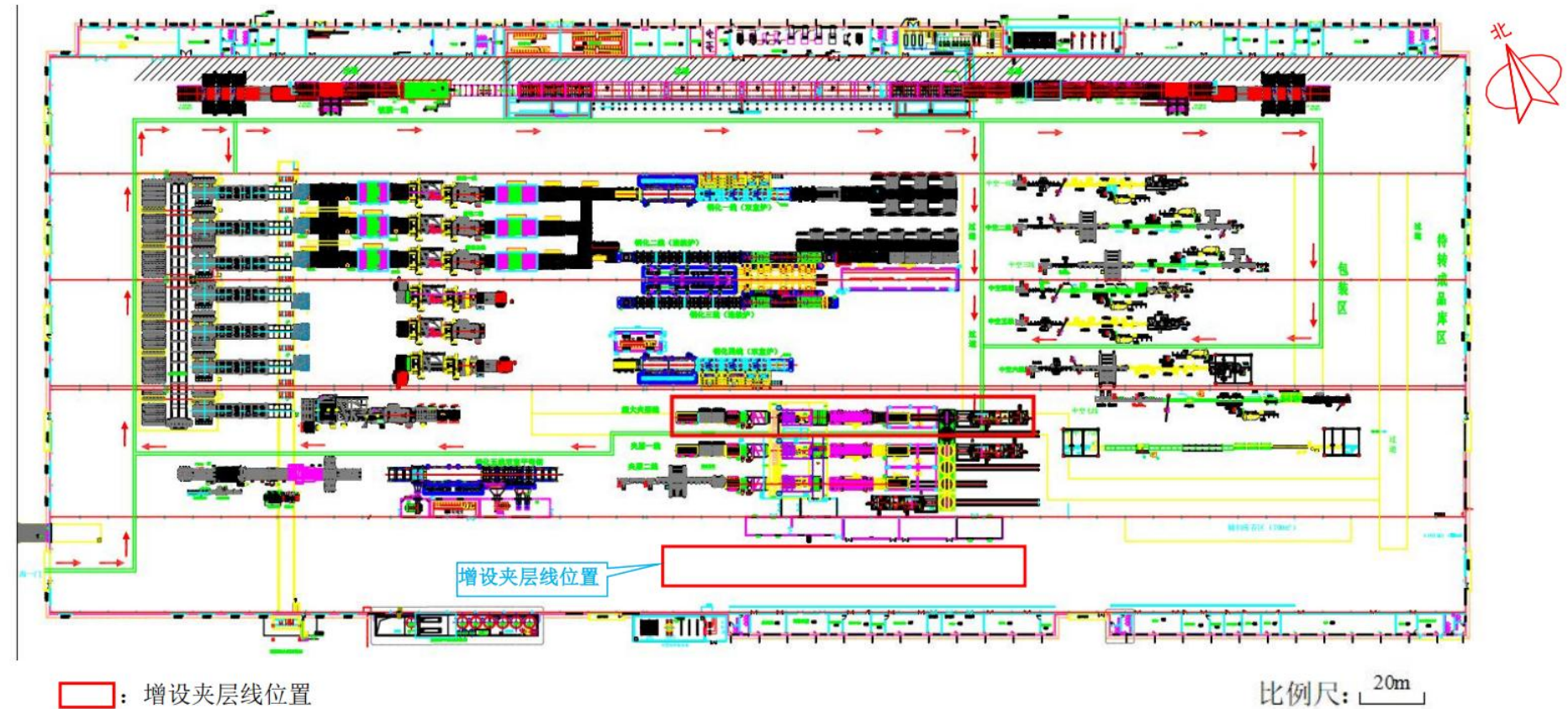
附图 4 扩建项目增设夹层玻璃生产线平面布局图
